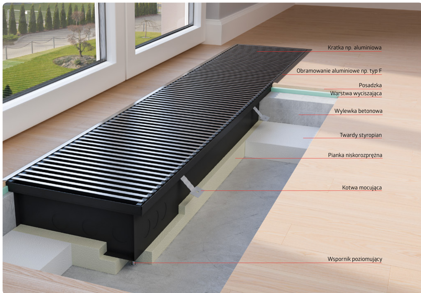
Przykładowy montaż płytkego grzejnika kanałowego
