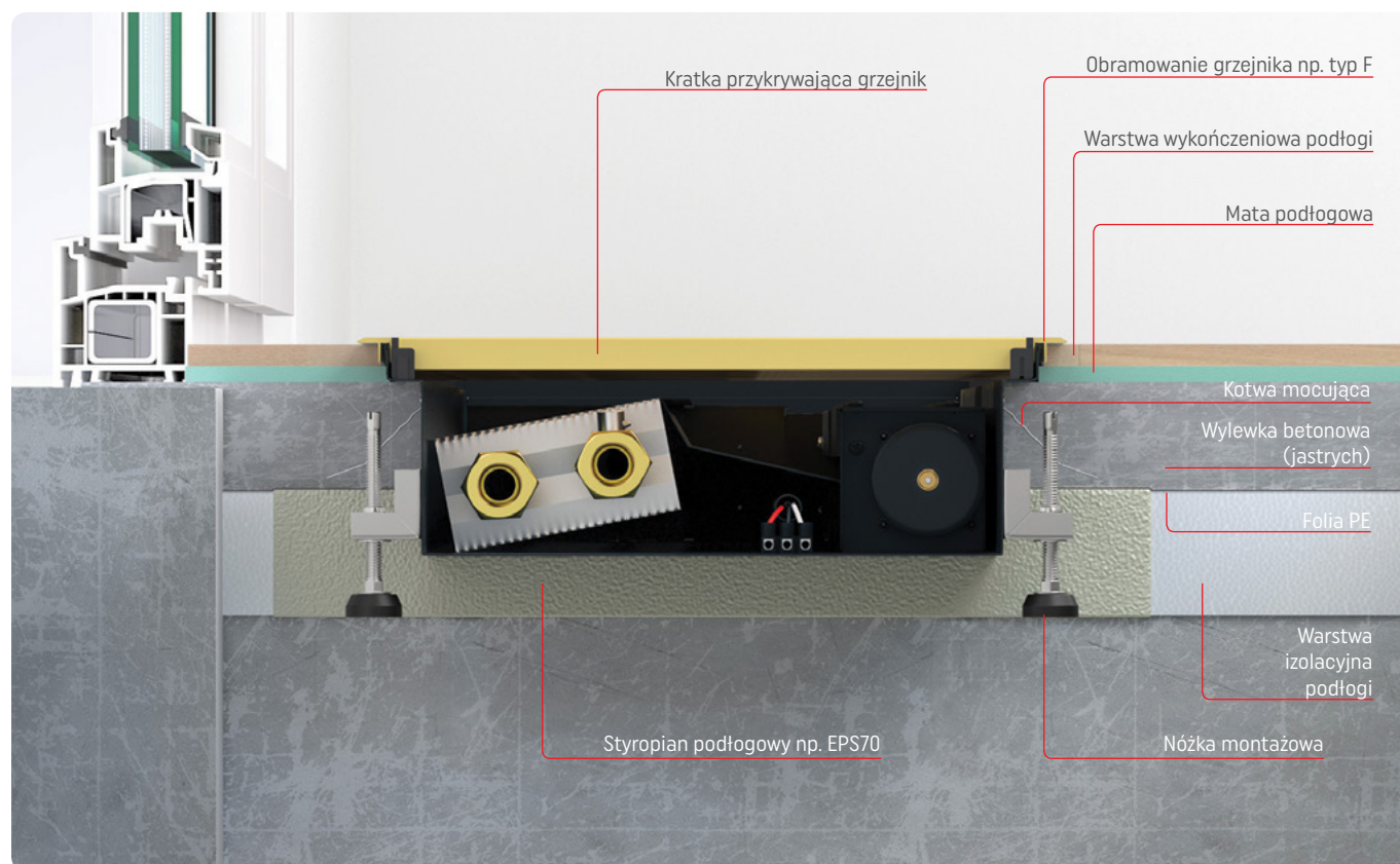
Przykład posadowienia grzejnika kanałowego z wentylatorem (widok z boku)
